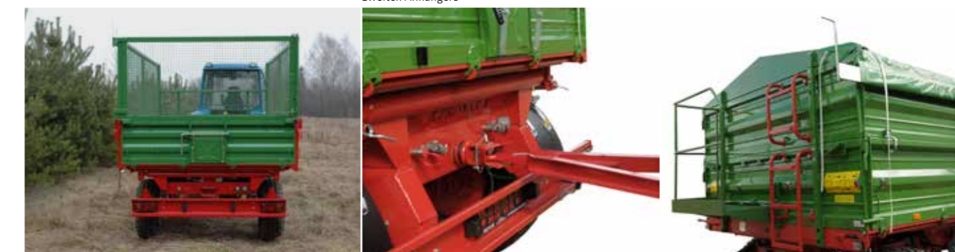
Anhängerkupplung ermöglicht das Aggregieren des zweiten Anhängers
